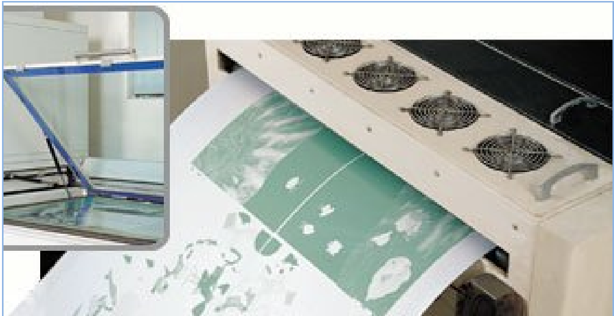
Hình minh họa một tấm bản in offset sau khi phơi bản, đang chạy ra khỏi máy hiện. Phần hình màu xanh bã đậu trên tấm bản in chính là màu của lớp nhựa diazo.
