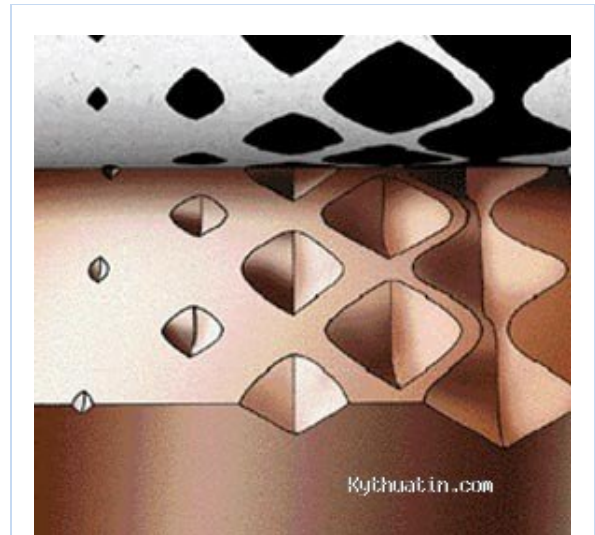
Hình mô phỏng bề mặt khuôn in ống đồng được phóng lớn, cho thấy các ô lõm khắc trên bề mặt trục
