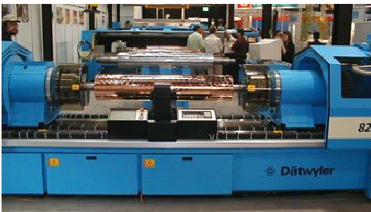
Trực in đang được tiện để làm phẳng bề mặt
