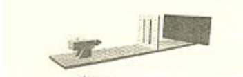
Hình 4.3. Trong thí nghiệm Young, chùm sáng chiếu vào một màn chắn có hai khe, ánh sáng đi qua hai khe được ghi lại trên tấm kính ảnh khi một trong hai khe hoặc cả hai khe đều mở.
